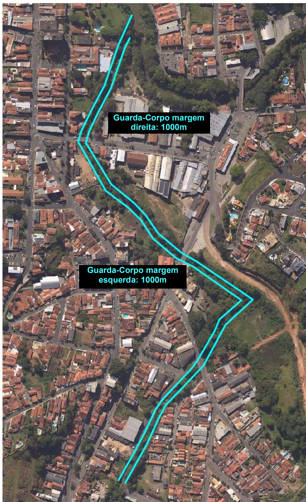
Figura 5 - Quantitativo de guarda-corpo na bacia Ribeirão dos Machados, nas duas margens do canal
