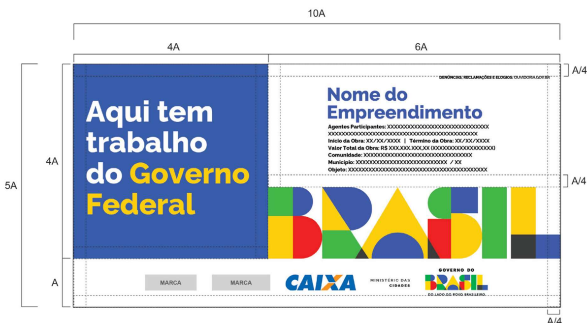
Figura 1 – Exemplo de dimensionamento das placas.
