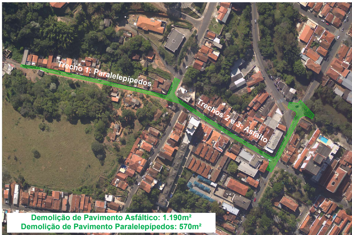
Figura 7 – Áreas de demolição e recomposição de pavimento na bacia do São Bento
