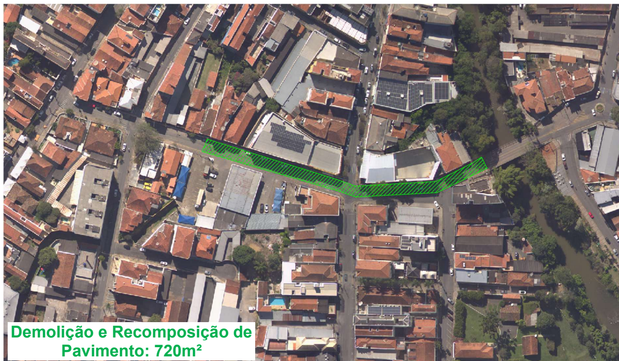
Figura 5 – Áreas de demolição e recomposição de pavimento na bacia do Barrocão
