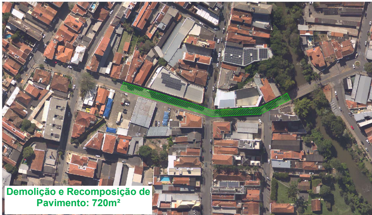
Figura 16 – Áreas de demolição e recomposição de pavimento na bacia do Barroco
