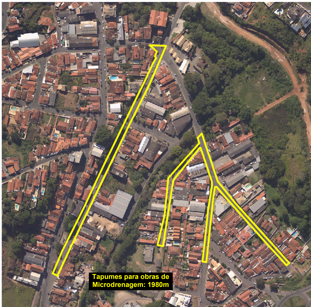
Figura 5 – Tapumes de cercamento da área de intervenção em microdrenagem na bacia do Ribeirão dos Machados
