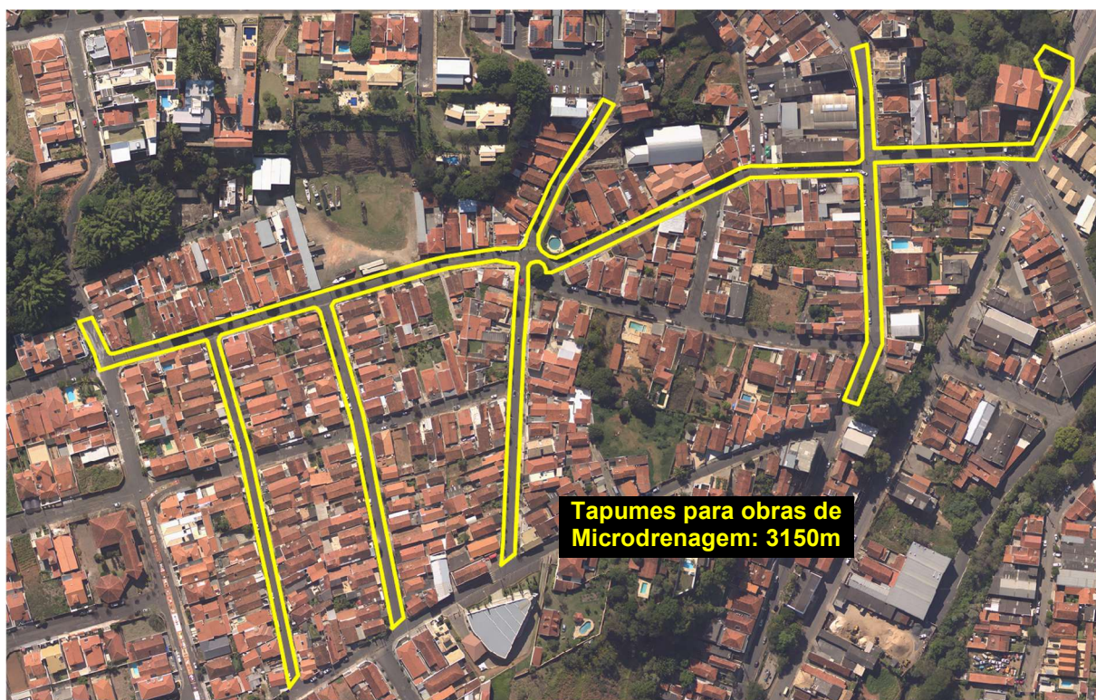
Figura 4 – Tapumes de cercamento da área de intervenção em microdrenagem na bacia do bairro N. Sra. Aparecida
