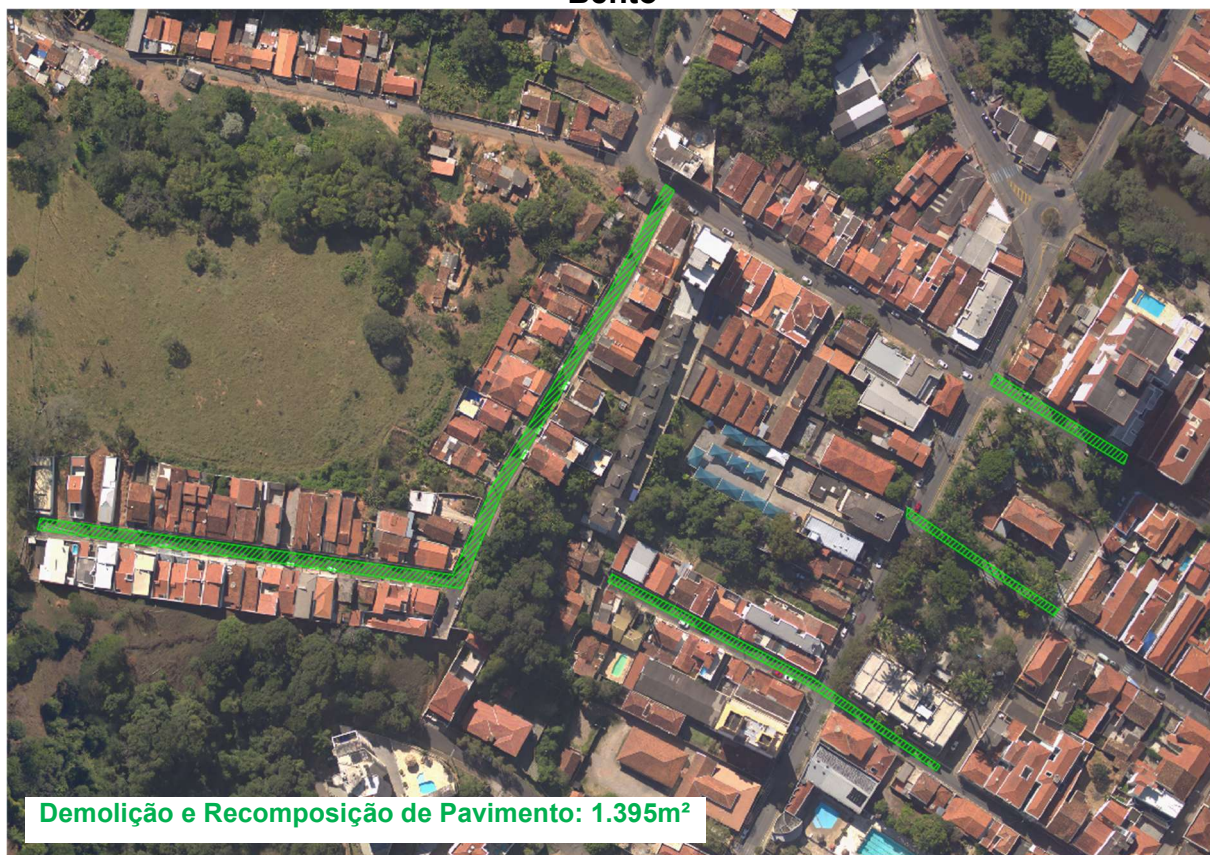
Figura 7 – Áreas de demolição e recomposição de pavimento na bacia do São Bento
