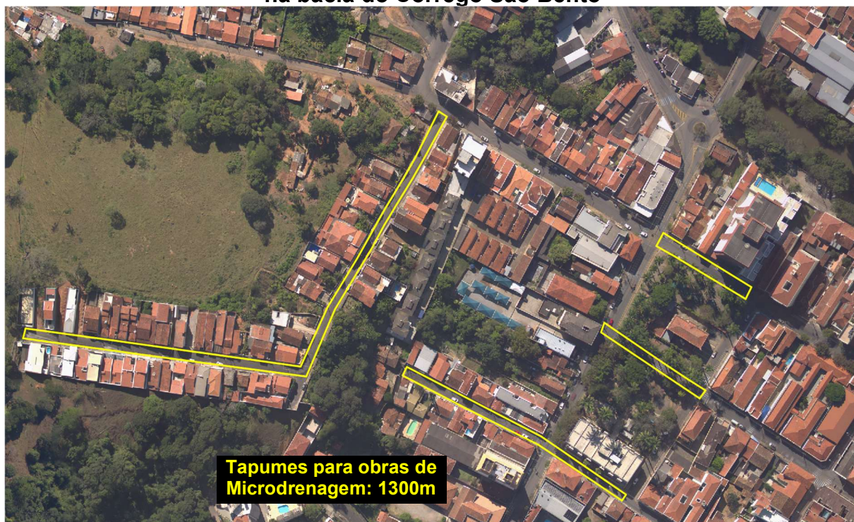
Figura 3 – Tapumes de cercamento da área de intervenção em microdrenagem na bacia do Córrego São Bento
