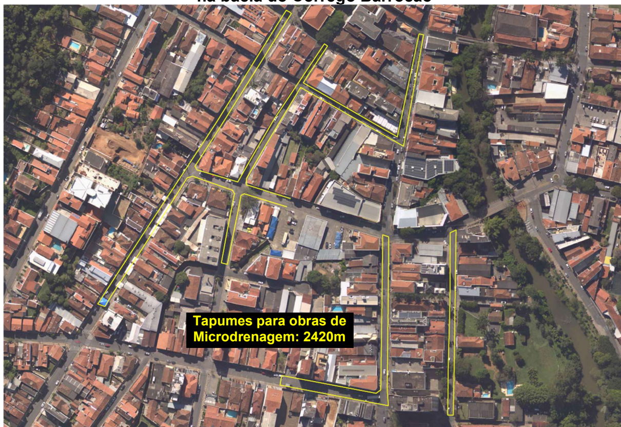
Figura 2 – Tapumes de cercamento da área de intervenção em microdrenagem na bacia do Córrego Barroco
