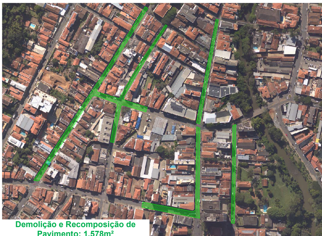
Figura 14 – Áreas de demolição e recomposição de pavimento na bacia do Barroco
