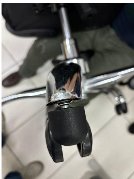
Extremidades do pé da cadeira apresentam pontos de ferrugem.
