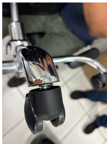
Extremidades do pé da cadeira apresentam pontos de ferrugem.
